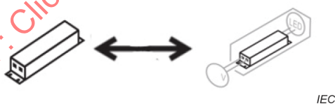
Figure 30 – Pictogramme pour un appareillage de commande remplaçable
